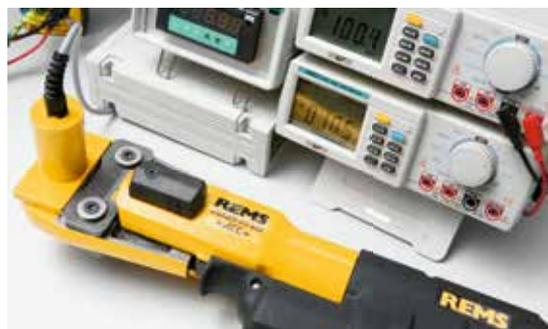
Сервис в REMS – сервис с большой буквы: все презентационные машины у 200-а консультантов REMS снабжены испытательным приспособлением, с помощью которого везде на месте можно осуществить проверку работы и силы сжатия радиальных прессов REMS.
