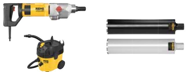
Компактный, удобный электроинструмент для кольцевого сверления, напр., в бетоне, железобетоне, кирпичной кладке всех видов, природном камне, асфальте, бесшовном полу всех видов. С регулировкой скоростей. Мокрого и сухого сверления, вручную и с использования стойки. Для мастерских и промышленности.
