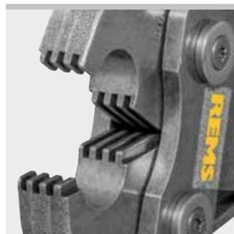
Обжимные клещи с зубчатым зацеплением
